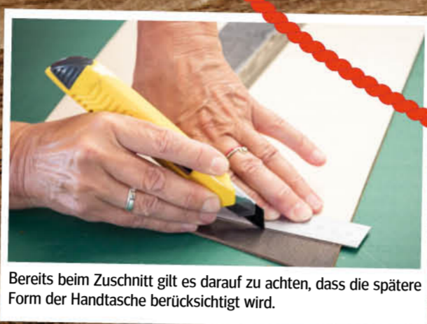
Am Anfang steht der Zuschnitt des Leders: Die Taschentelle werden mit einer Schablone und Metalllineal umrissen.
