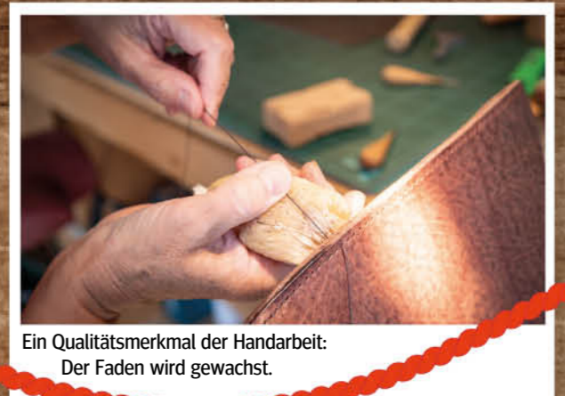
Die Seitennaht der Handtasche wird doppelt vernäht: Schließlich soll die Tasche möglichst lange halten.
