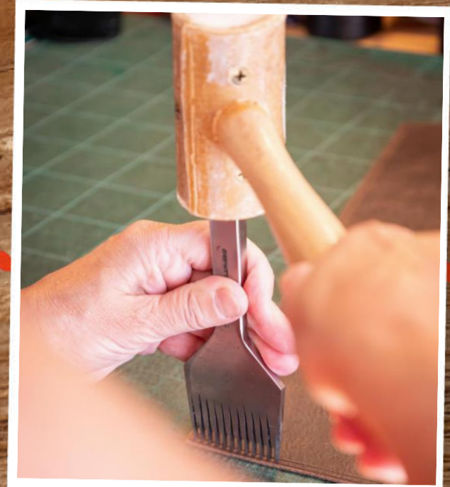
Mit dem Prickeisen – einem gabelähnlichen Werkzeug – werden die Nahtlöcher markiert.
