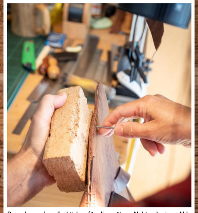
Danach werden die Löcher für die spätere Naht mit einer Ahle vorgestochen. Der Korken dient für den Gegendruck.
